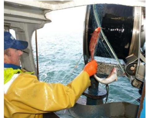
Relevage des filets grâce au vire-filet.
