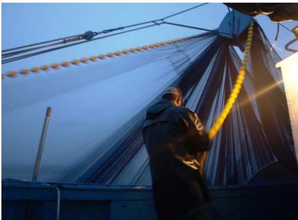
La première partie de la senne (le tale) est ensuite virée à l'aide d'un power block : les flotteurs, la corde de plomb, les margouillots et la toile sont rangés progressivement à bord, ramenant peu à peu le poisson sur le flanc du navire.
